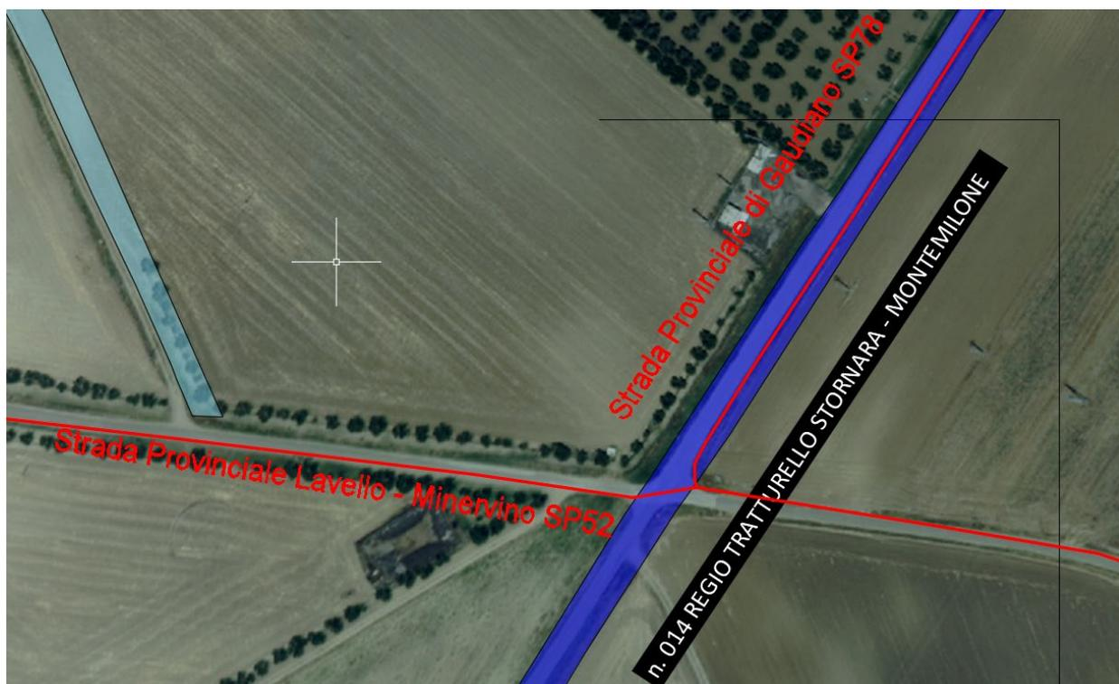
Figura 3: intersezione trasversale del cavidotto di progetto con il Regio Tratturello Stornara – Montemilone
