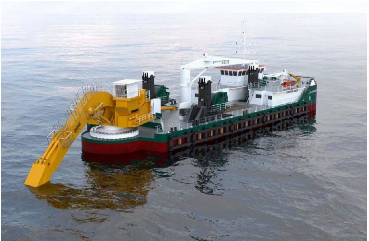
Figura 4-7 – Lavori di preparazione all'uscita del foro a mare dell'TOC - Esempio di draga retro-escavatrice
