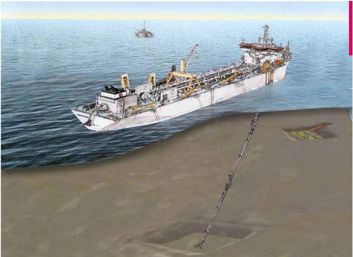
Figura 4-4 – Lavori di preparazione all'uscita a mare dell'TOC - Schema della draga aspirante da taglio
