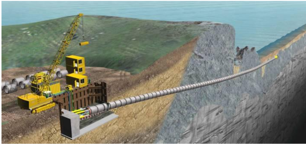
Figura 3-48 – Fase di scavo del microtunnel
