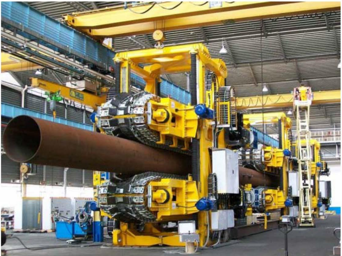
Figura 4-20 – Nave posa tubi - Configurazione tipica dei tensionatori
