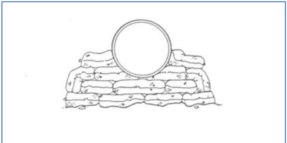
Figura 4-69 Supportazione della condotta - Tipico supporto post-posa con sacchetti di sabbia
