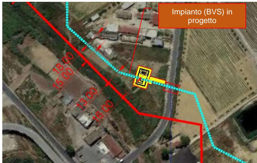
Figura 11 – Particolare distanza dalle arginature di edifici e impianto in progetto con ortofoto
