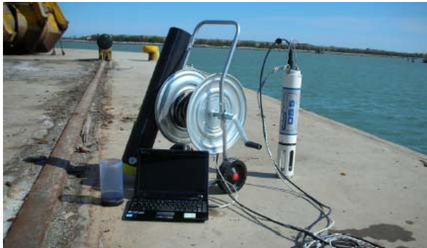
Figura 6.1 Esempio di strumentazione (Hydrolab DS5) collegata a notebook per la visione diretta dei valori misurati durante l'esecuzione del profilo verticale
