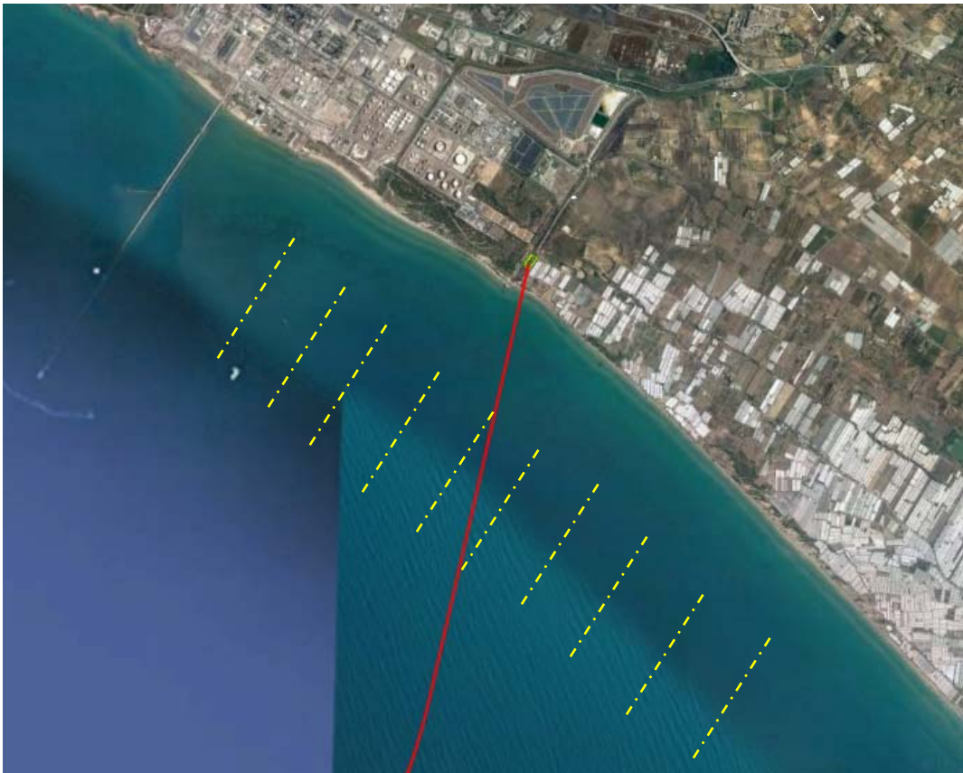
Figura 6.4 Planimetria con l’ubicazione dei transetti di misura ADCP e le linee di navigazione eseguite
