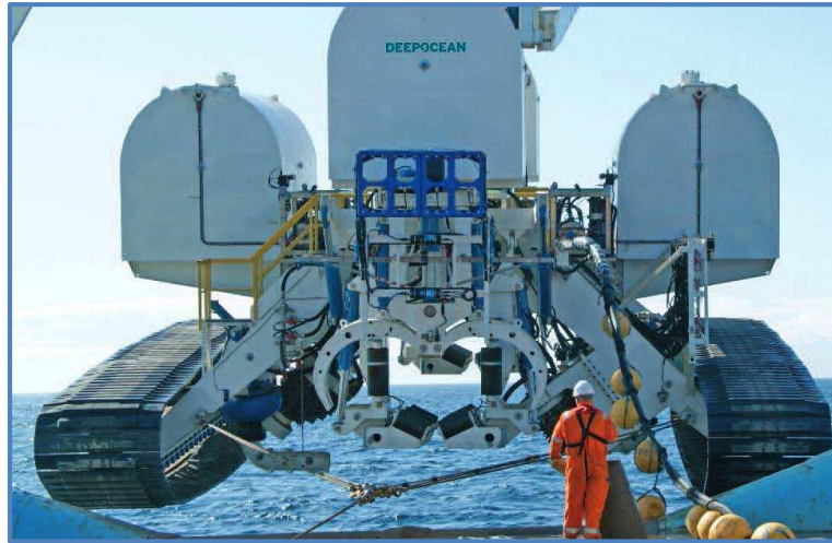
Figura 3.5.36: Lavori di scavo post-posa – Esempio di macchina di scavo “cutting & suction”
