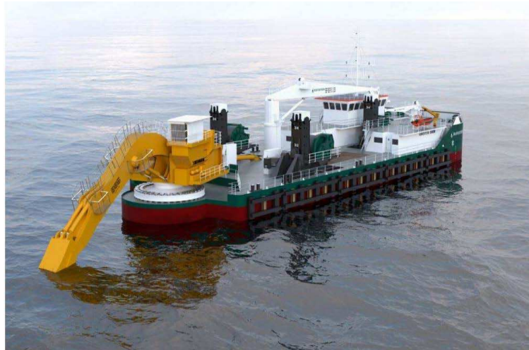
Figura 3.5.22: Lavori di preparazione all'uscita del foro a mare della TOC - Esempio di draga retro-escavatrice
