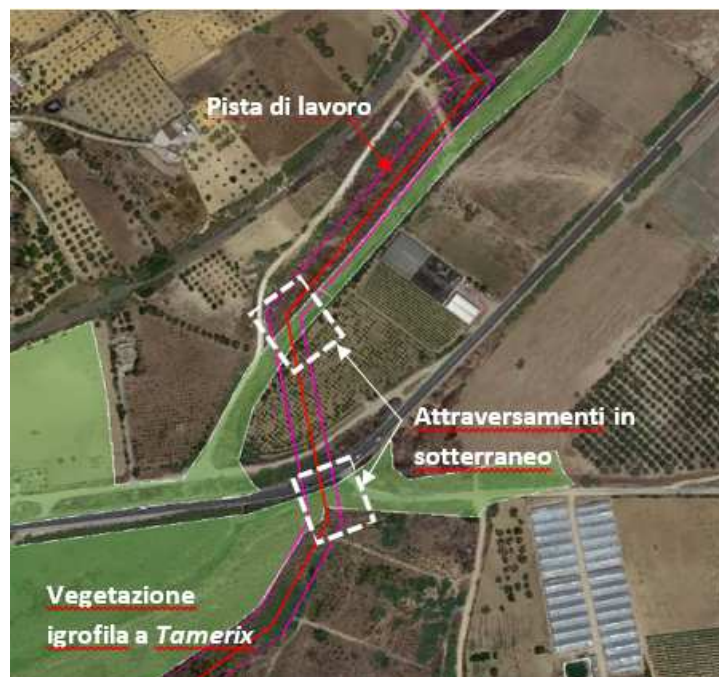
Figura 5.4.5: Stralcio su ortofoto con localizzazione della pista di lavoro (in viola) e degli attraversamenti del Canale Priolo previsti in sotterraneo (rettangoli bianchi)
