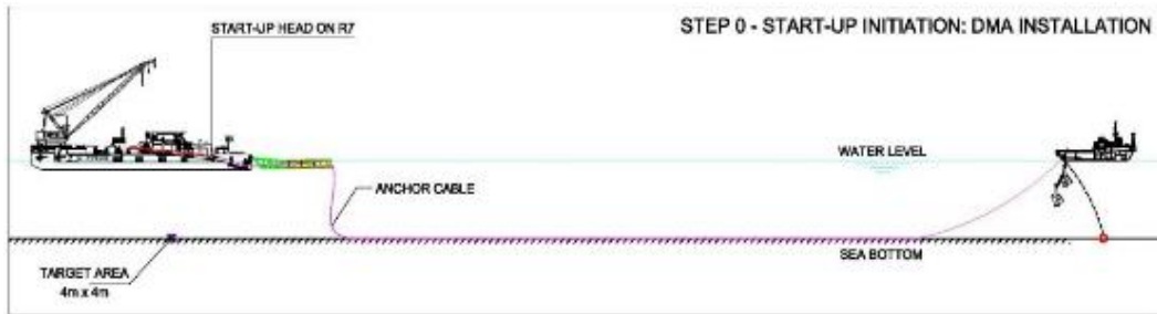
Figura 2-9 Processo di posa di P/L in S-lay – Inizio varo– step 0
