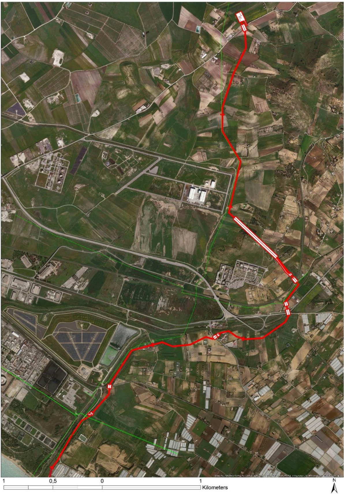
Figura 2 Fotografia aerea con il percorso del gasdotto, in rosso, e quello dei gasdotti/oleodotti già esistenti, in verde.
