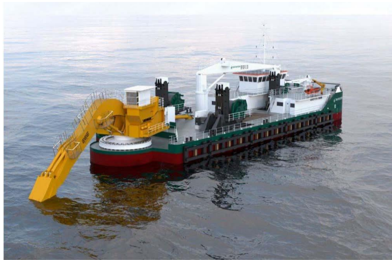
Figura 2.4.22: Lavori di preparazione all'uscita del foro a mare della TOC - Esempio di draga retro-escavatrice
