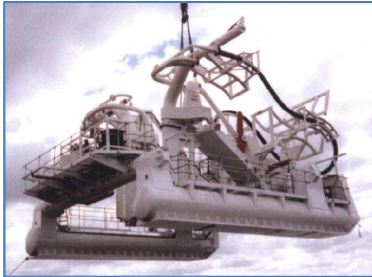
Figura 2.4.34: Lavori di scavo post-posa – Esempio di macchina da scavo a “water jetting”
