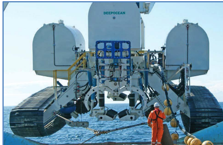
Figura 2.4.36: Lavori di scavo post-posa – Esempio di macchina di scavo “cutting & suction”
