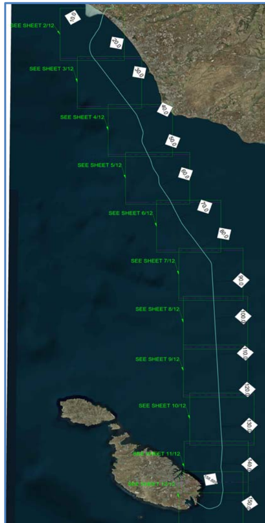
Figura 5-3 Rotta generale della condotta
