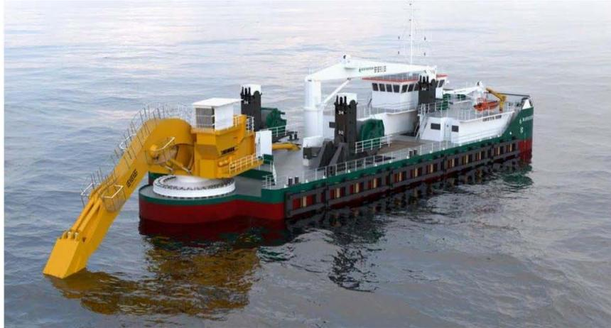
Figura 14: Lavori di preparazione all'uscita del foro a mare della TOC - Esempio di draga retro-escavatrice
