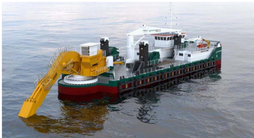
Figura 13: Xogħolijiet ta’ thejjija fil-ħruġ ta’ trinka tal-HDD ‘il barra mill-kosta – Eżempju ta’ Backhoe Dredger
