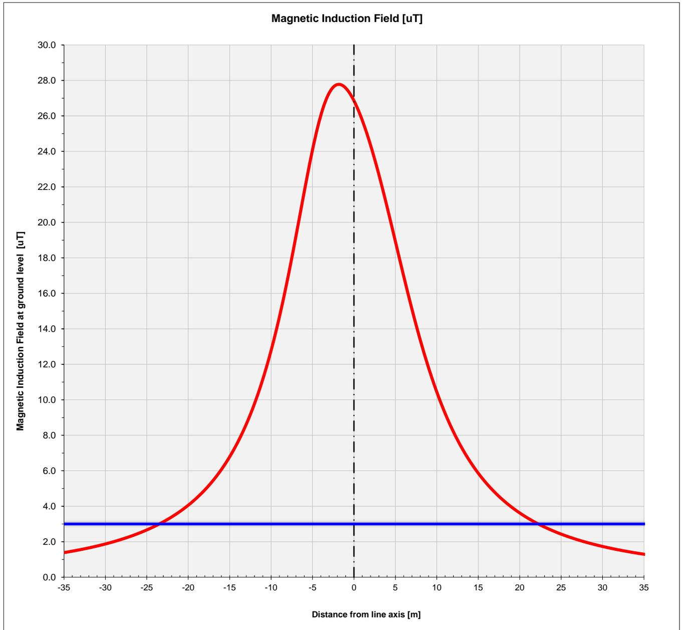
**Fig. 1: andamento dell'induzione magnetica in una sezione perpendicolare all'asse linea, calcolata a 1,5 m dal suolo in caso di franco minimo (obiettivo di qualità pari a 3  $\mu$ T)**
