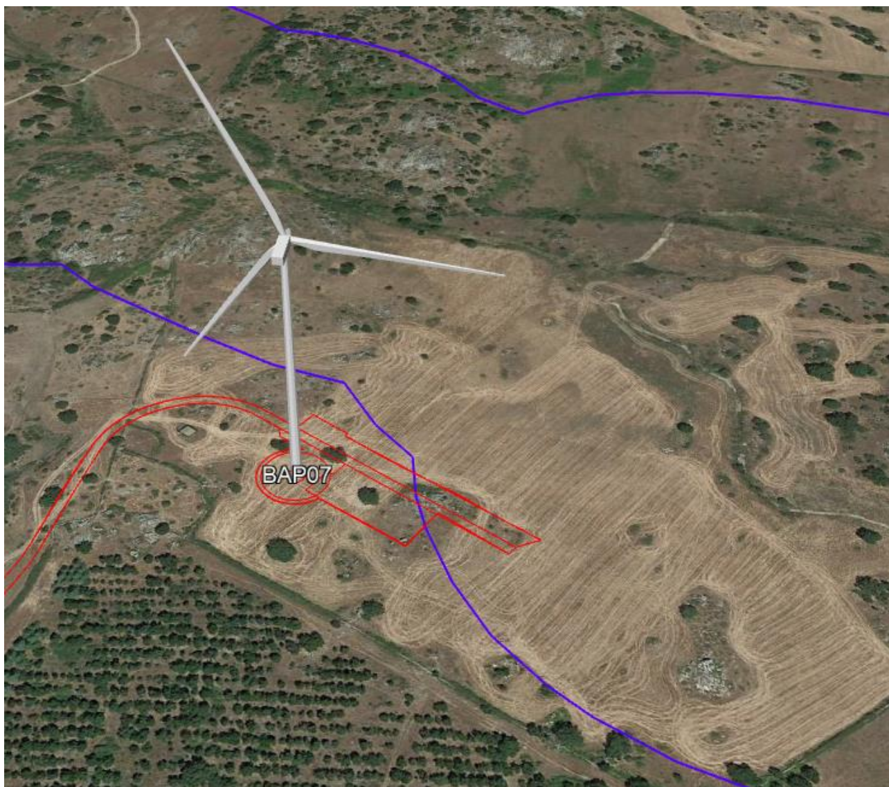
Figura 7.6 – Sovrapposizione delle opere previste in corrispondenza della fascia di tutela di 150 m del corso d'acqua tutelato dal Codice Urbani
