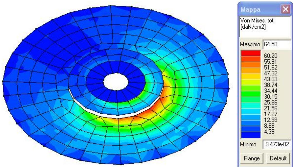
*Mapa cromatica delle tensioni totali (membrana + flessione) ottenute mediante la formulazione di Von Mises –
