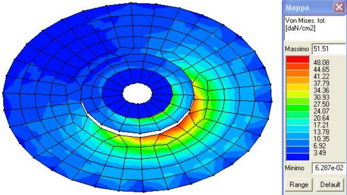
*Mapa cromatica delle tensioni totali (membrana + flessione) ottenute mediante la formulazione di Von Mises –
