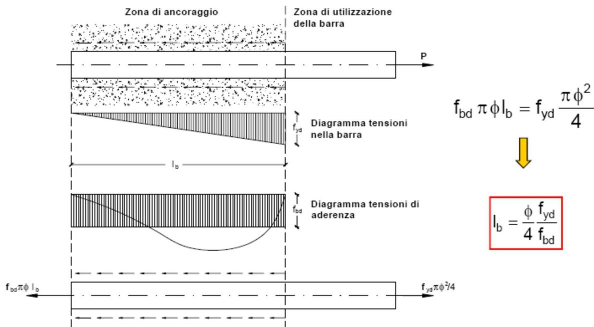
dove  $f_{bd} = f_{bk} / \alpha_c$  è la tensione tangenziale di aderenza acciaio-calcestruzzo e  $f_{bk} = 2.25 \alpha_c f_{ctk}$  è la resistenza tangenziale caratteristica di aderenza ( $\alpha_c = 1$  per  $\phi \leq 32$  mm).
