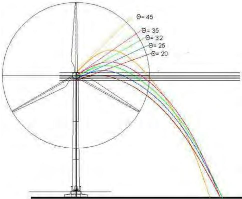
In conclusione scegliendo il valore che rappresenta le condizioni più gravose ossia quello con un angolo di lancio  $\theta = 26^\circ$  e sommando la sua distanza orizzontale dal baricentro e la distanza del vertice della pala (56,67 m) si ha la distanza massima degli elementi rotanti in caso di rottura accidentale è di circa 199,73 m.
