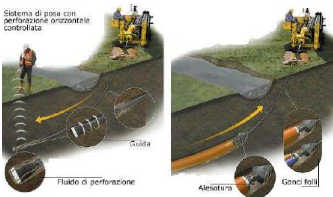
Posa in opera tubazione con trivellazione teleguidata
