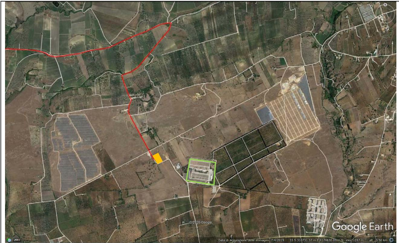
Riquadro R3: tracciato del nuovo elettrodotto in MT, si può osservare che vengono certamente interessate viabilità esistenti. In arancione l'ingombro della nuova sottostazione, la linea in verde indica il perimetro della esistente Stazione Elettrica Partanna
