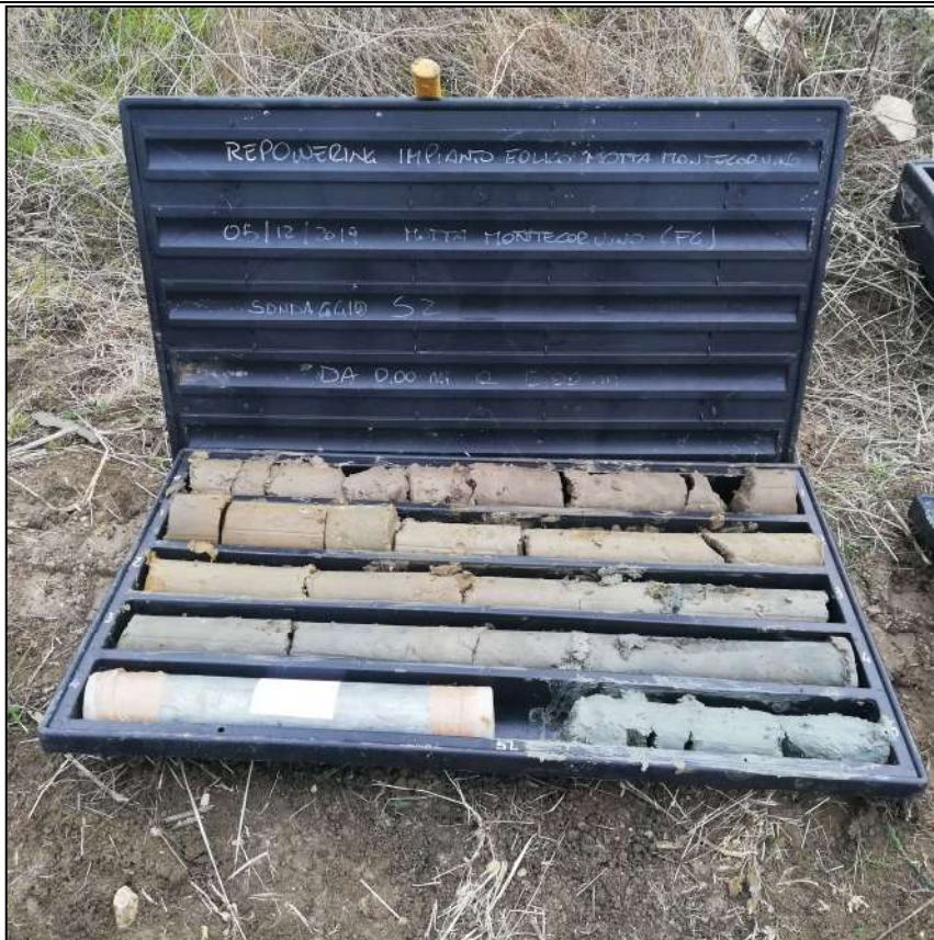
Cassetta catalogatrice 1 di 6: carote da 0,00 m a 5,00 m
