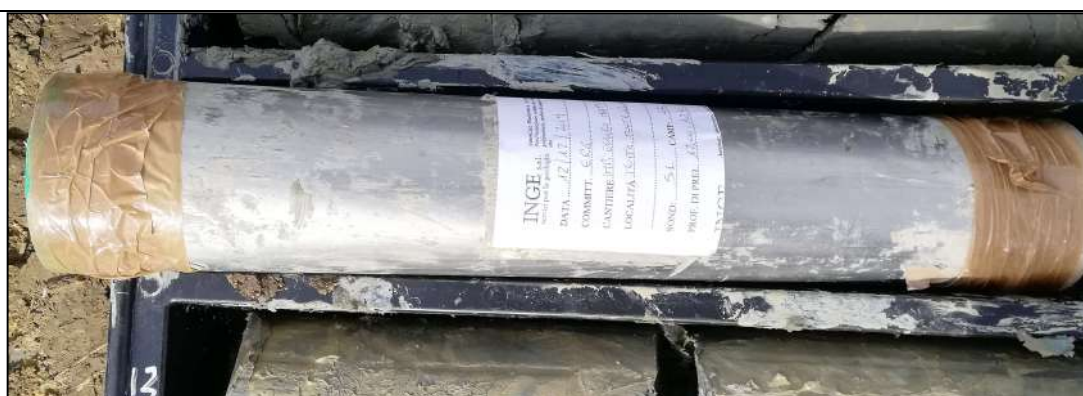
Campione indisturbato S1-C2: da 12,00 m a 12,50 m
