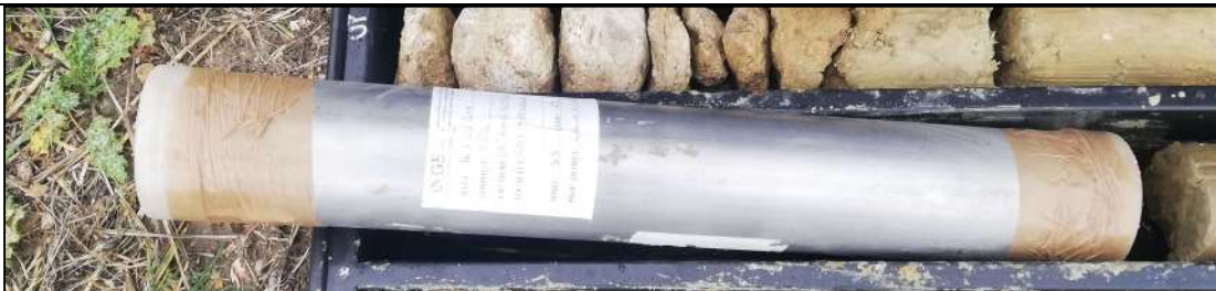
Campione indisturbato S3-C1: da 6,00 m a 6,50 m
