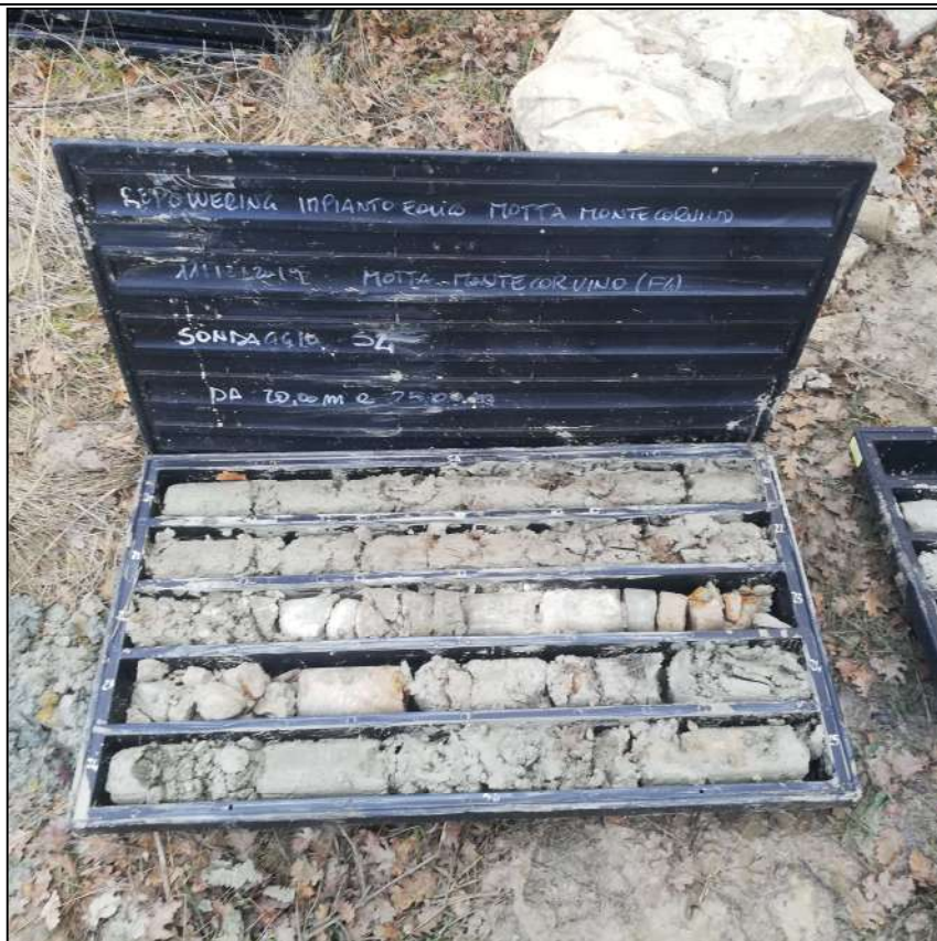
Cassetta catalogatrice 5 di 6: carote da 20,00 m a 25,00 m
