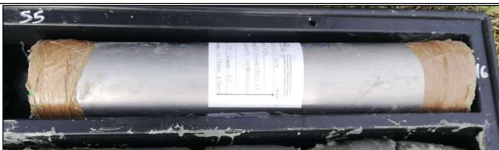
Campione indisturbato S5-C2: da 15,50 m a 16,00 m
