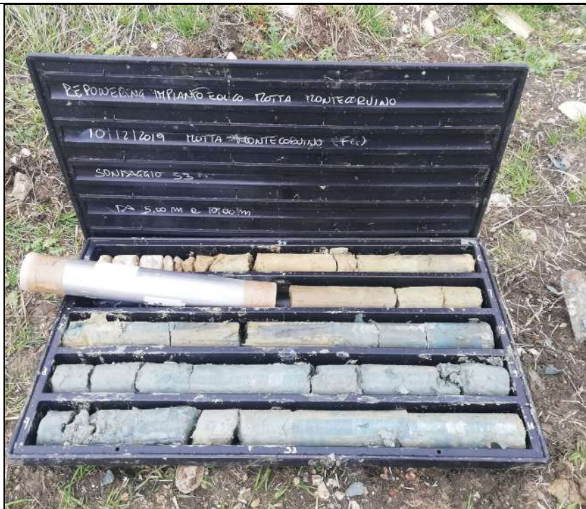
Cassetta catalogatrice 2 di 6: carote da 5,00 m a 10,00 m
