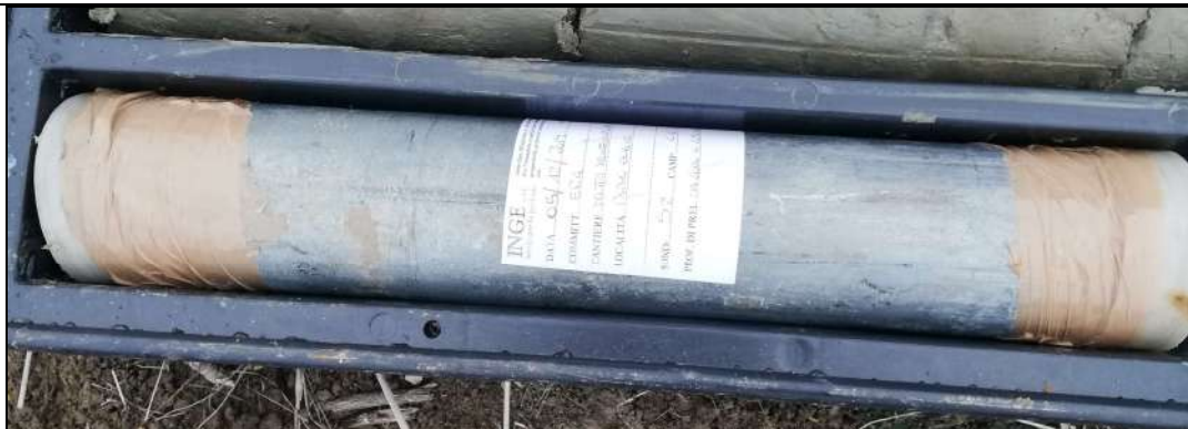
Campione indisturbato S2-C1: da 4,00 m a 4,50 m
