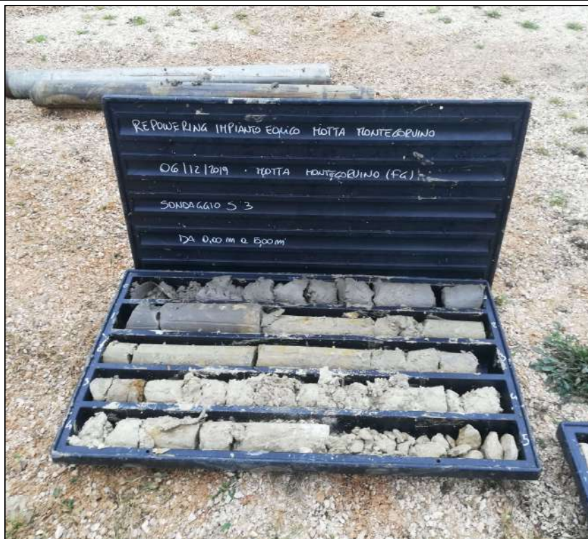
Cassetta catalogatrice 1 di 6: carote da 0,00 m a 5,00 m
