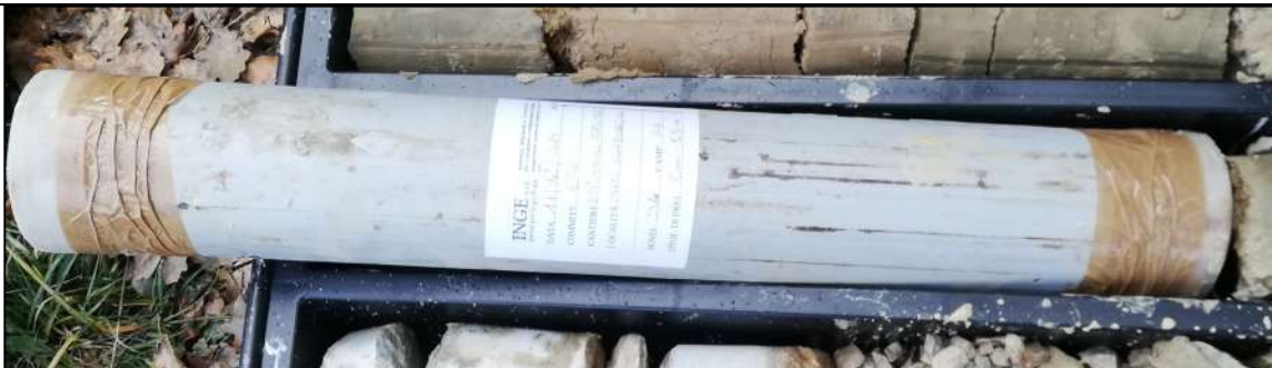
Campione indisturbato S4-C1: da 8,00 m a 8,50 m
