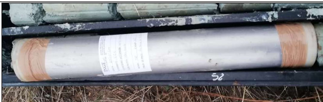
Campione indisturbato S2-C2: da 14,30 m a 14,80 m
