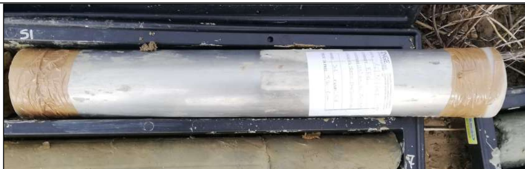
Campione indisturbato S1-C1: da 5,50 m a 6,00 m
