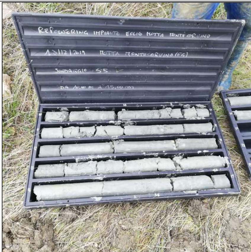
Cassetta catalogatrice 3 di 6: carote da 10,00 m a 15,00 m
