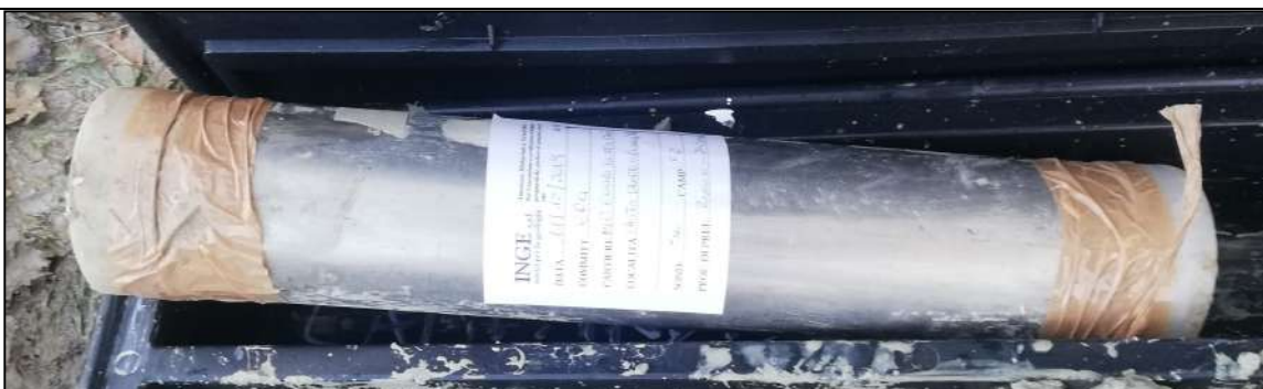
Campione indisturbato S4-C2: da 20,00 m a 20,50 m
