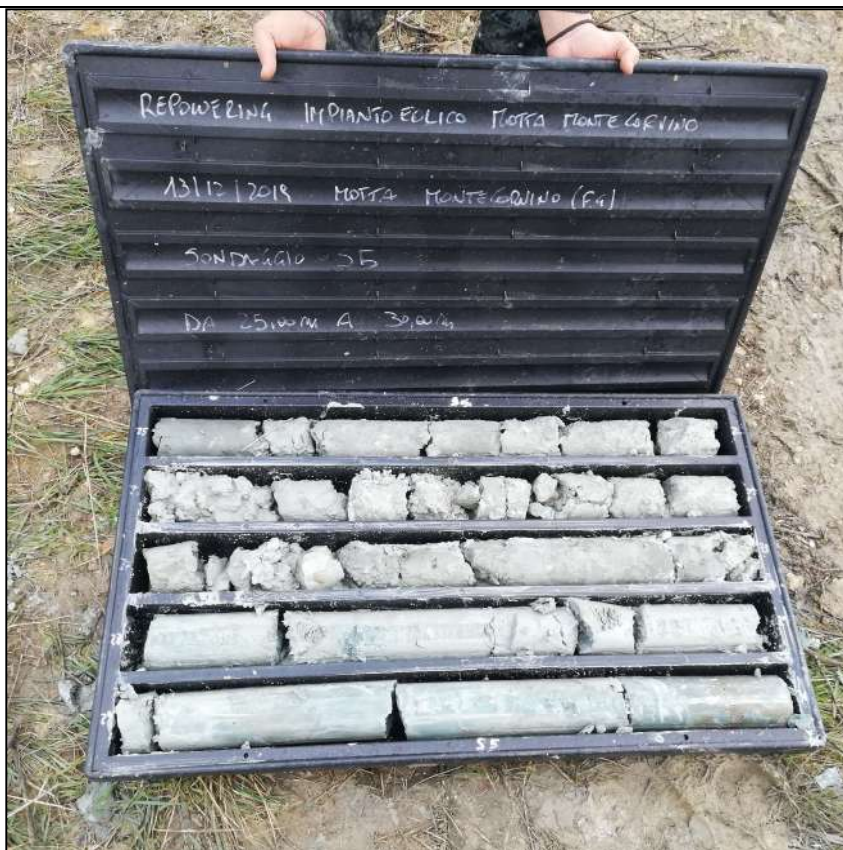
Cassetta catalogatrice 6 di 6: carote da 25,00 m a 30,00 m
