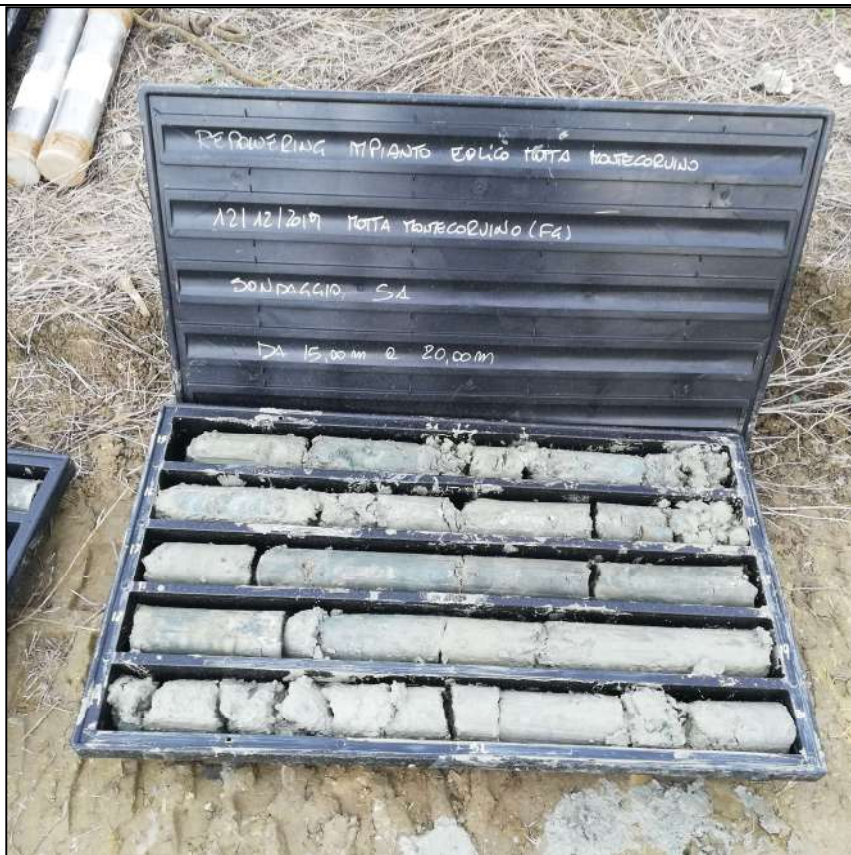
Cassetta catalogatrice 4 di 6: carote da 15,00 m a 20,00 m
