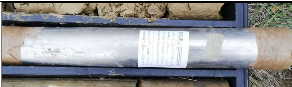
Campione indisturbato S5-C1: da 2,00 m a 2,50 m
