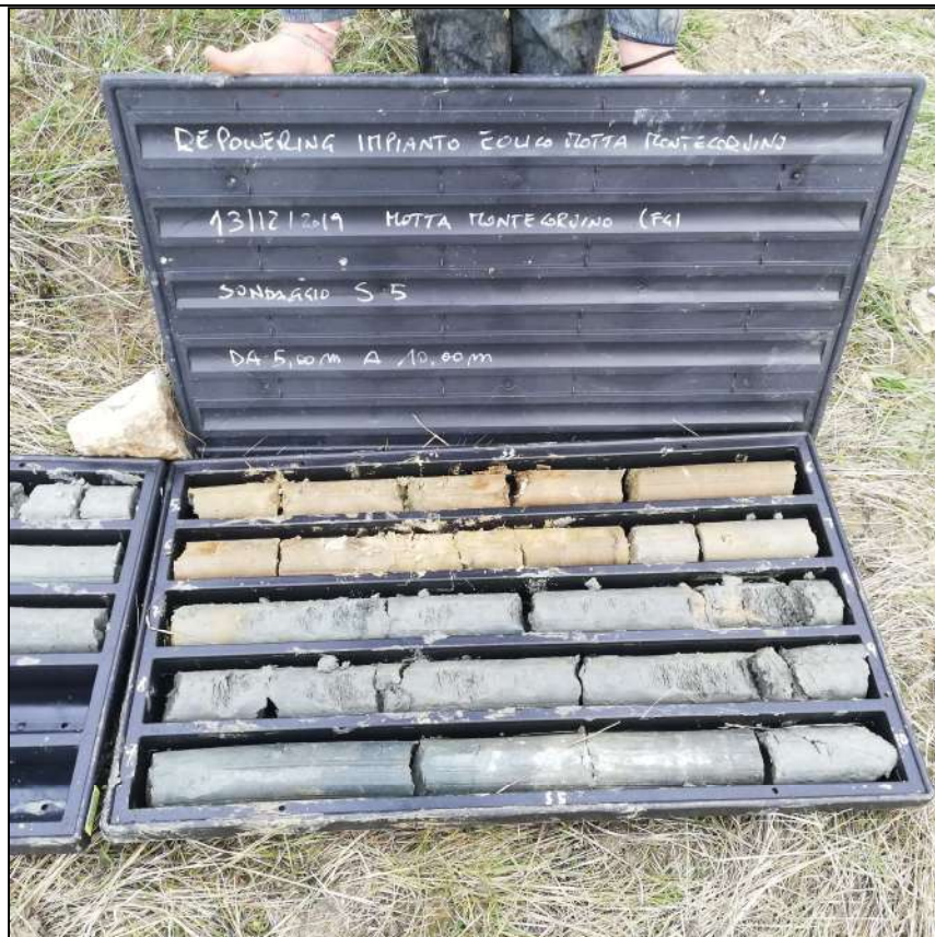
Cassetta catalogatrice 2 di 6: carote da 5,00 m a 10,00 m
