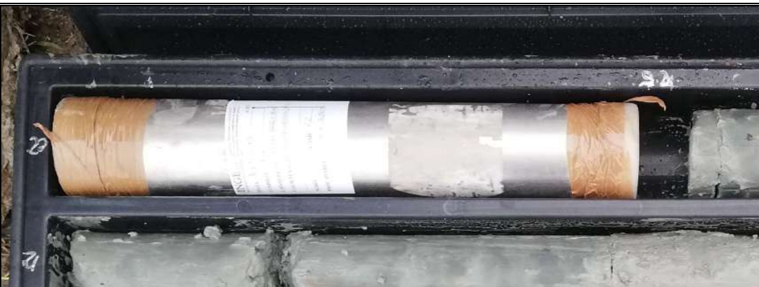
Campione indisturbato S3-C2: da 20,00 m a 20,50 m
