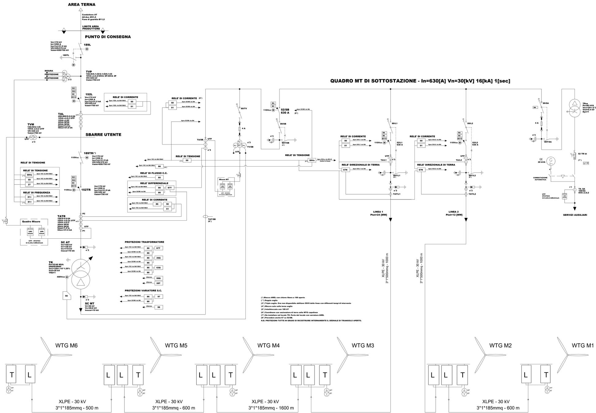
QUADRO MT DI SOTTOSTAZIONE - In=630[A] Vn=30[kV] 16[kA] 1[sec]
