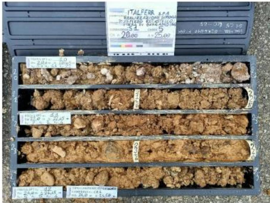
Figura 7 - Sondaggio S1, profondità 20,00-25,00 m
