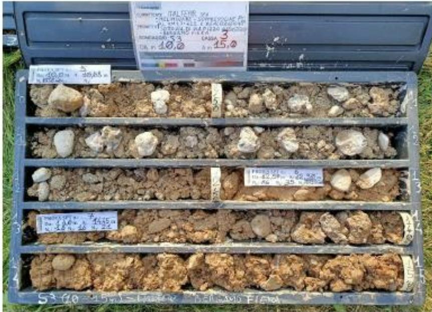
Figura 15 - Sondaggio S3, profondità 10,00-15,00 m
