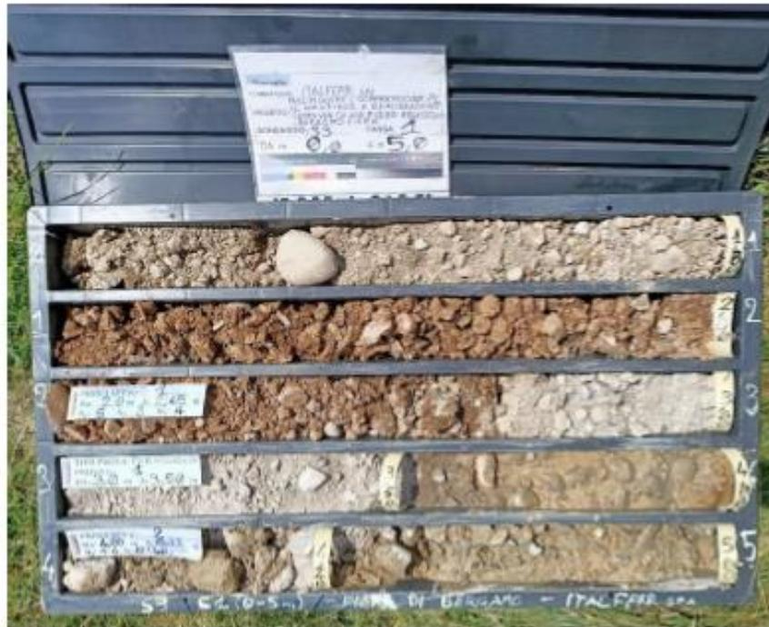
Figura 13 - Sondaggio S3, profondità 0,00-5,00 m.
