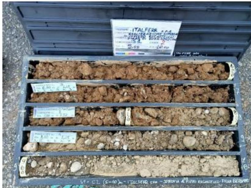
Figura 4 - Sondaggio S1, profondità 5,00-10,00 m.
