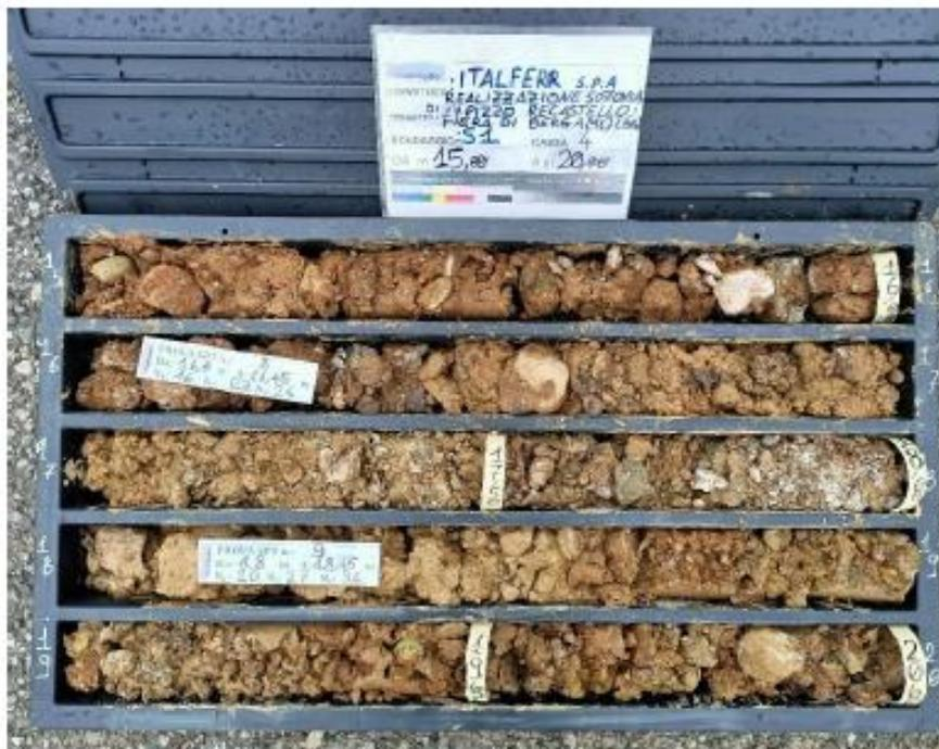
Figura 6 - Sondaggio S1, profondità 15,00-20,00 m
