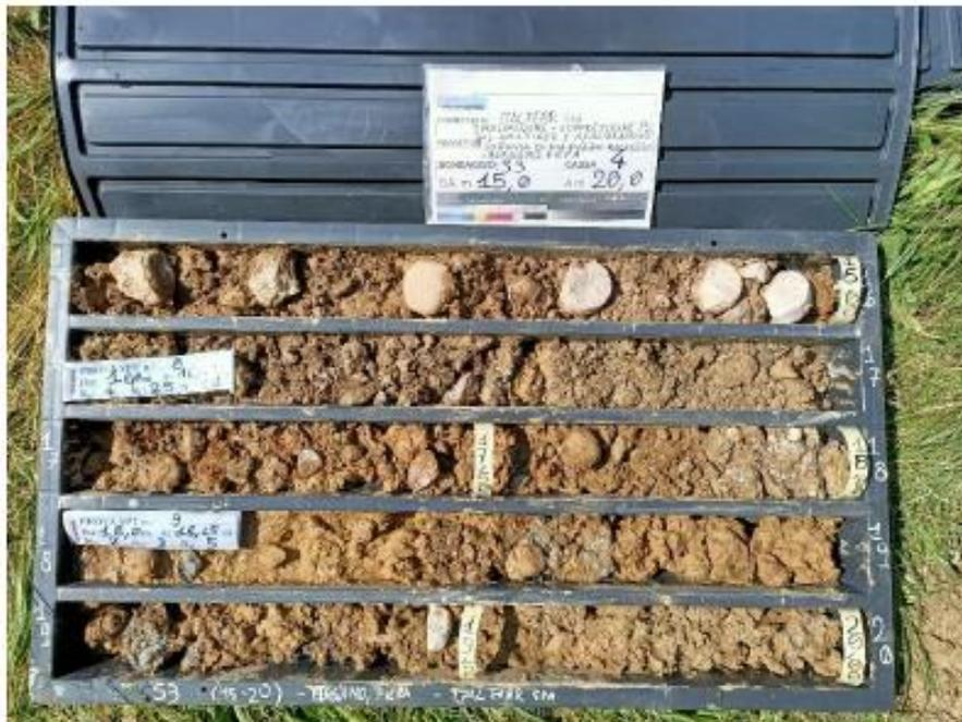
Figura 16 - Sondaggio S3, profondità 15,00-20,00 m
