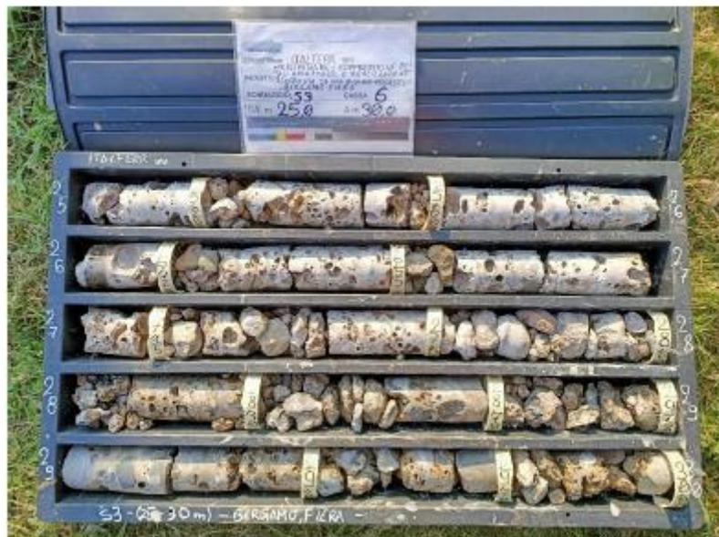
Figura 18 - Sondaggio S3, profondità 25,00-30,00 m
