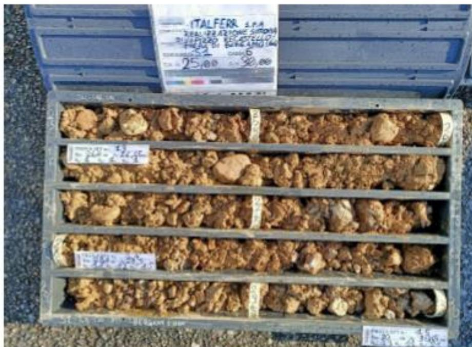
Figura 8 - Sondaggio S1, profondità 25,00-30,00 m
