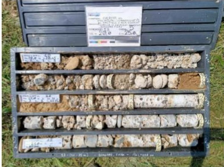
Figura 17 - Sondaggio S3, profondità 20,00-25,00 m
