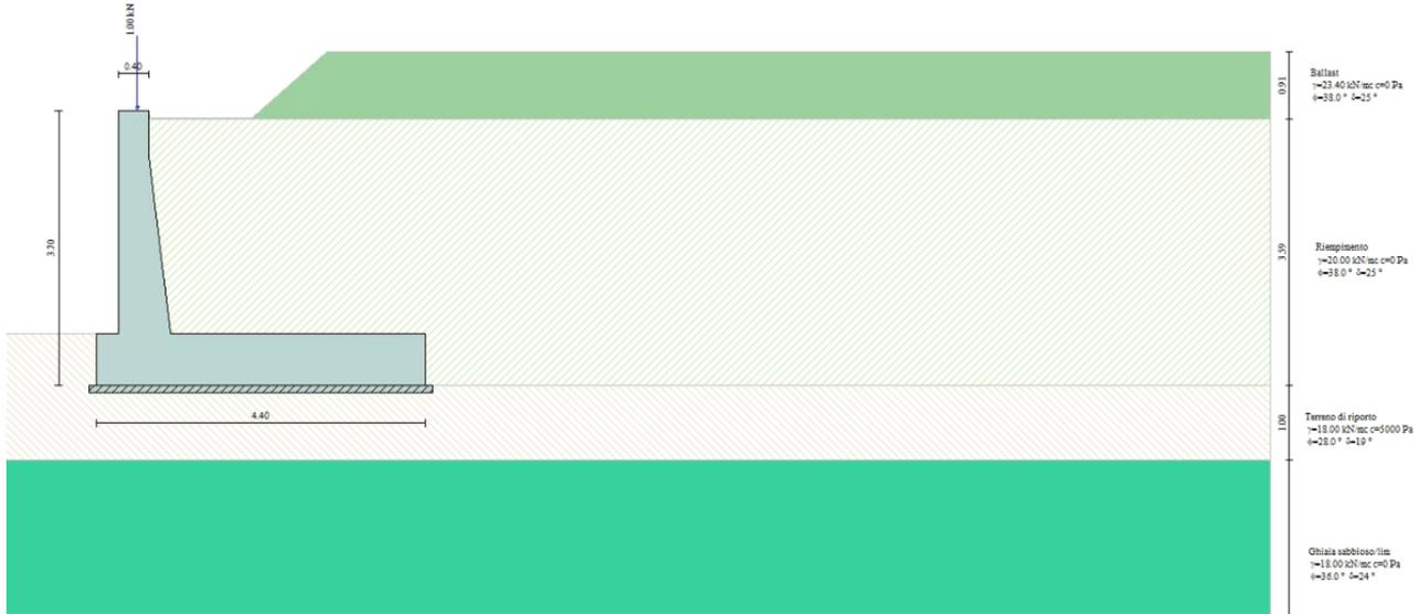
**Figura 8-20 – Rappresentazione degli strati di ballast e terreno spingente in MAX14 per la combinazione A2**
