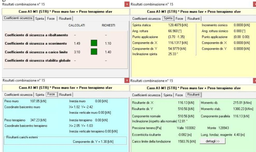
**Figura 8-36 – Risultati verifica al carico limite (da MAX 14)**
