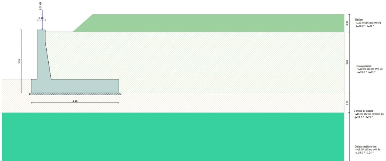
**Figura 8-33 – Rappresentazione degli strati di ballast e terreno spingente in MAX14 per la combinazione A2**
