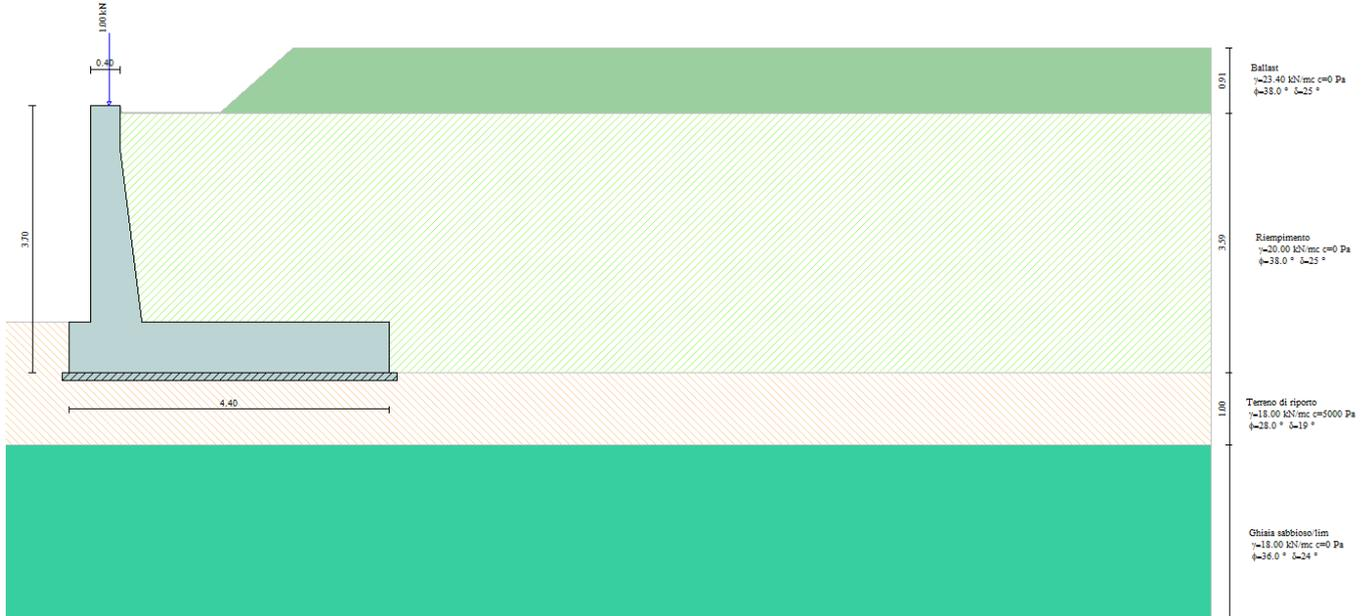
**Figura 8-7 – Rappresentazione degli strati di ballast e terreno spingente in MAX14 per la combinazione A2**
