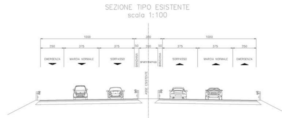
Figura 3-1 Sezione tipo piattaforma autostradale esistente
