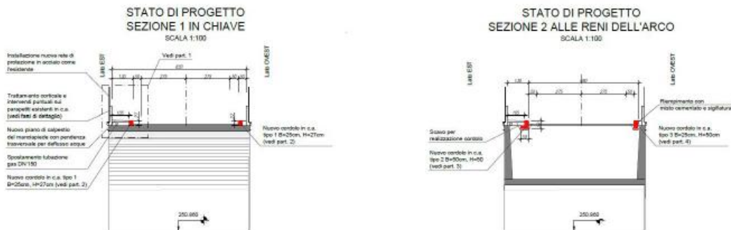
Intervento di sostituzione dei cordoli esistenti
