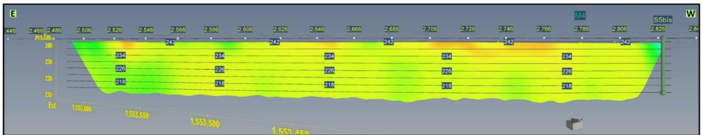
Figura 4-46 - Sezione dei valori di resistività elettrica relativa all’area E3D_D, vista da Nord.
