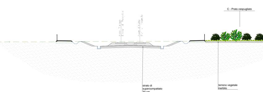
Sezione corrente pk 4+500 con riportati i tipologici delle opere a verde. Scala 1:200
