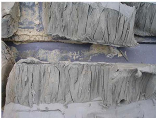
**Foto 3.1. Particolare della sottile stratificazione rilevabile da una carota di sondaggio**
