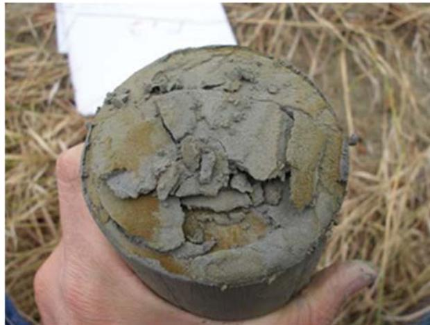
Foto 5.1. Sottile livello sabbioso nelle argille del substrato
