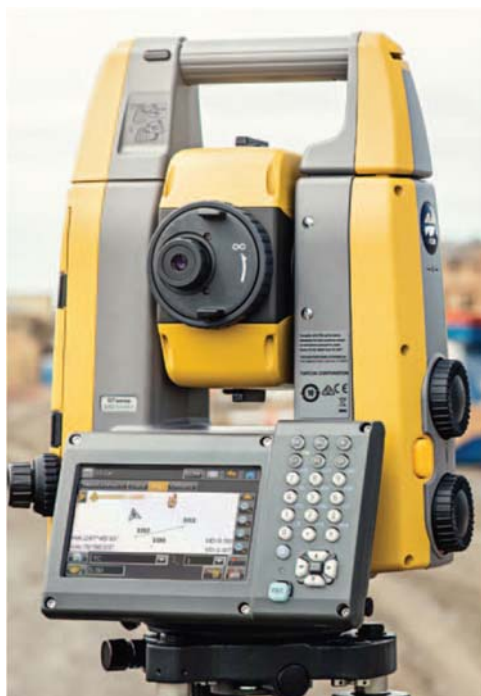
Figura 29 - Stazione Master monitoraggio
