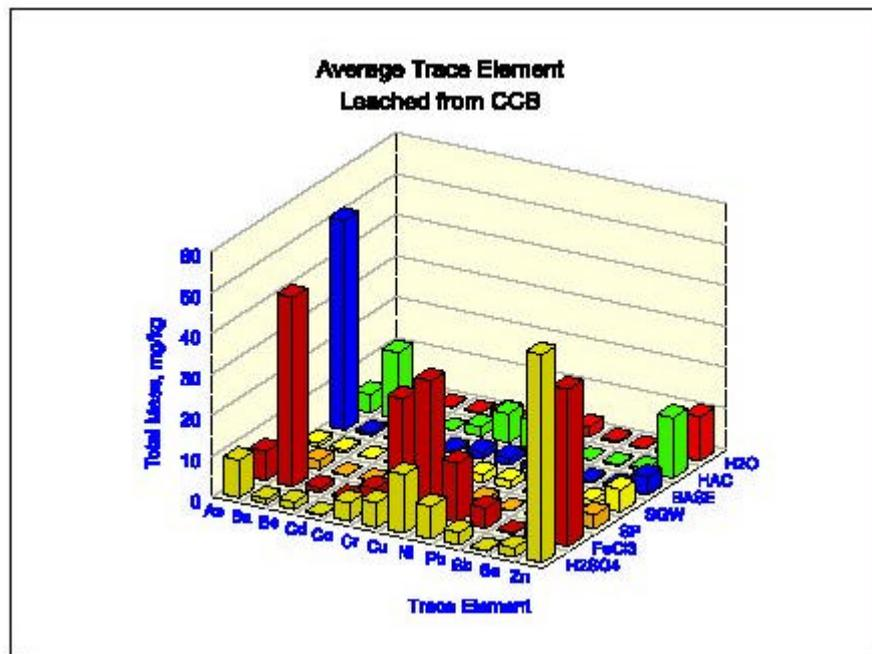
**Figura 7** - Concentrazioni medie di elementi in tracce nei prodotti di lisciviazione ottenuti dalle ceneri di carbone secondo differenti metodologie di prova
