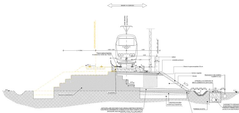
FASE 4: COMPLETAMENTO DEL RILEVATO DI PROGETTO E POSA DELL'ARMAMENTO AD INTERASSE 4.00m DAL BINARIO DI PROGETTO
