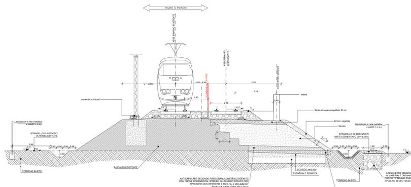
FASE 3: DEMOLIZIONE DEL BINARIO ESISTENTE E RIMOZIONE PARZIALE DEL RILEVATO
