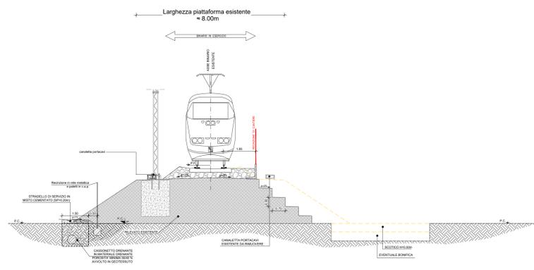
FASE 2: COMPLETAMENTO DEL RILEVATO E REALIZZAZIONE ARMAMENTO DEL BINARIO DI PROGETTO CON INTERASSE BINARI PARI A 4.00 - 5.50m
