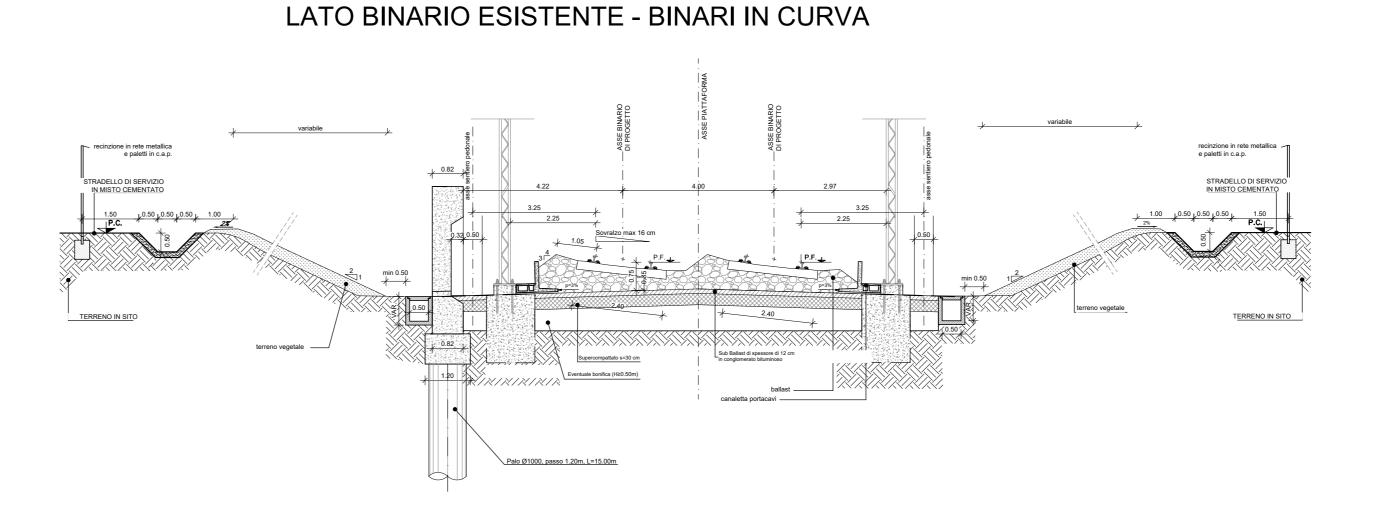
SEZIONE TIPO IN TRINCEA CON MURO DI RECINZIONE
