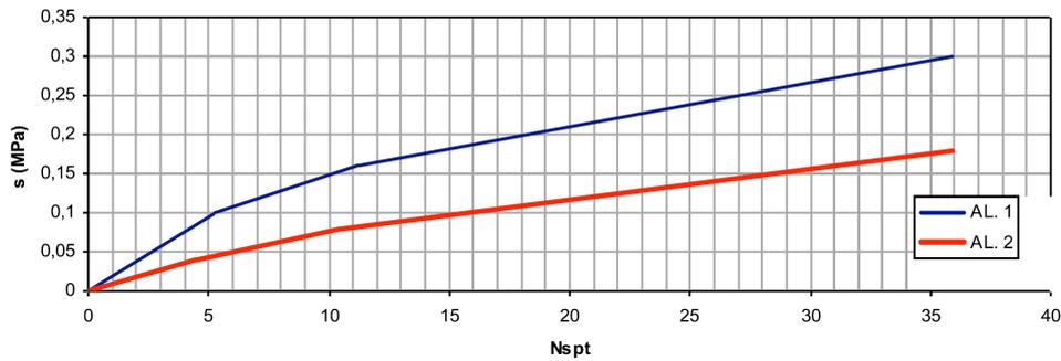
Figura 11 - Abaco per la determinazione di  $s$  per argille e limi
