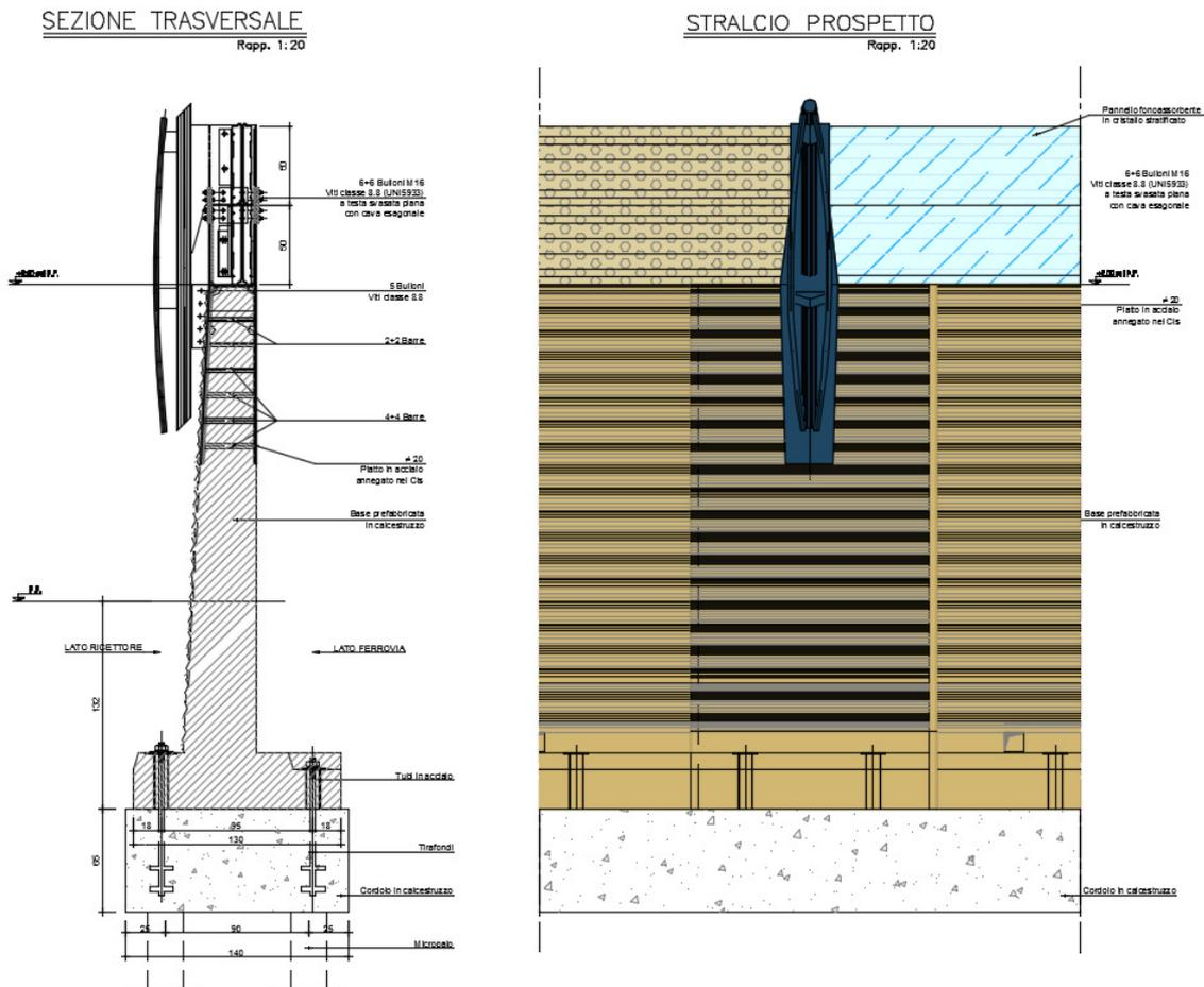
Figura 1 - Barriera verticalizzata
