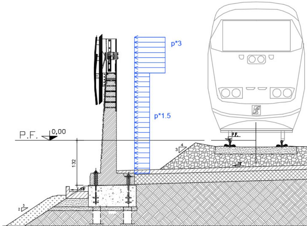
*Figura 6 - Andamento della pressione del vento con l'altezza della barriera.*
