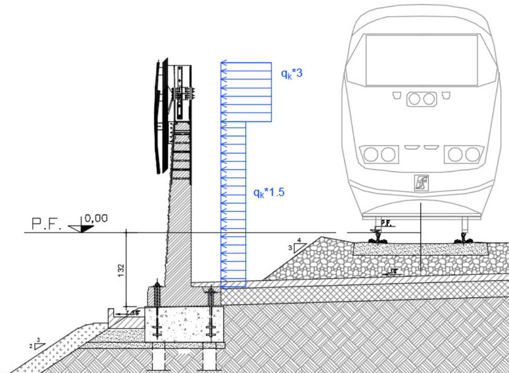
Figura 8 - Distribuzione delle pressioni sull'altezza della barriera
