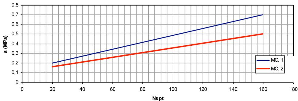
Figura 12 - Abaco per la determinazione di  $s$  per gessi, marne e marne calcaree
