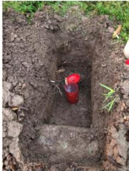
Dall'insieme dei risultati delle prove di permeabilità in pozzetto e delle prove di permeabilità Lefranc, sono stati definiti i valori di permeabilità per tratti omogenei di tracciato, riportati nella tabella 4 del paragrafo precedente.
