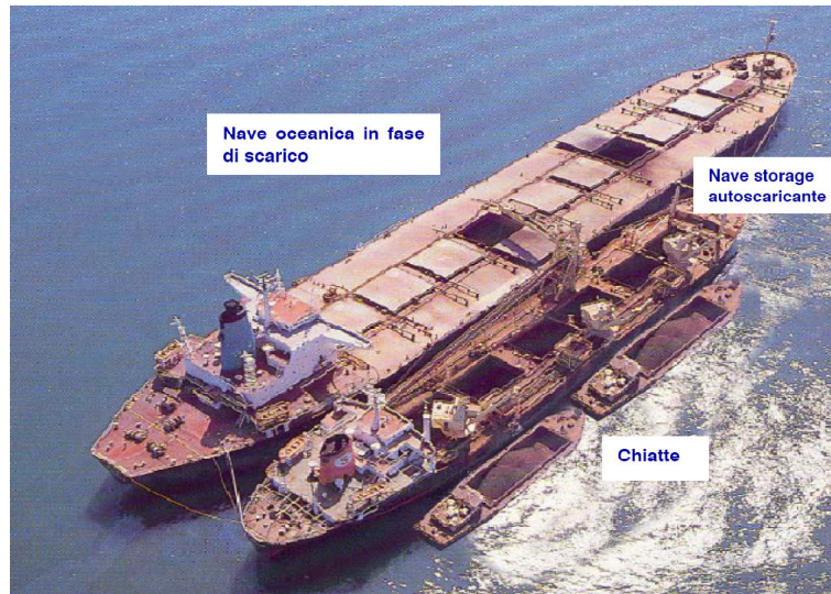
Figura 2-II Esempio di terminal off-shore con nave oceanica, nave storage e chiatte per il collegamento alla Centrale (fonte ENEL).
