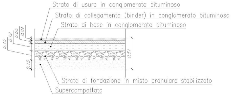
Figura 6: dettaglio pavimentazione
