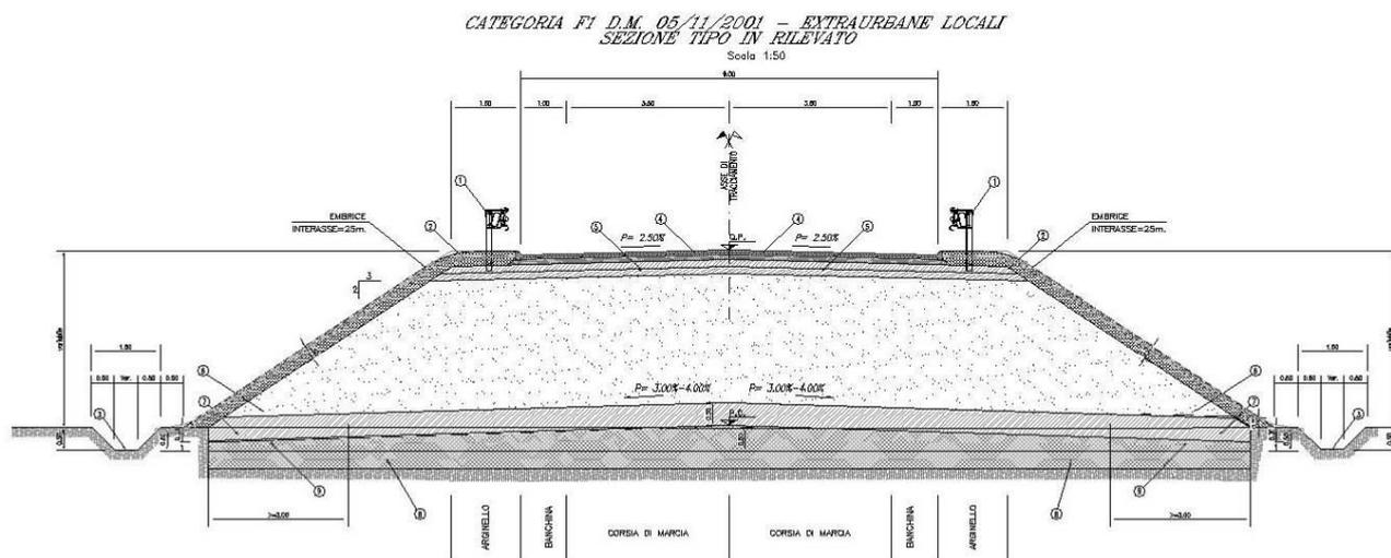
**Figura 4: sezione tipo in rilevato (H ≤ 5,00m)**
