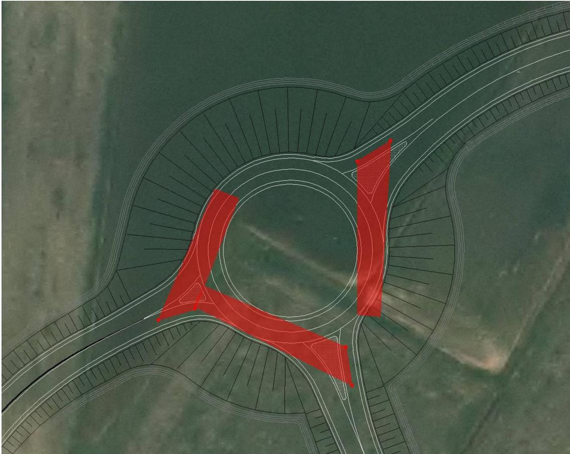
**Figura 9: verifica di visibilità rotatoria**
