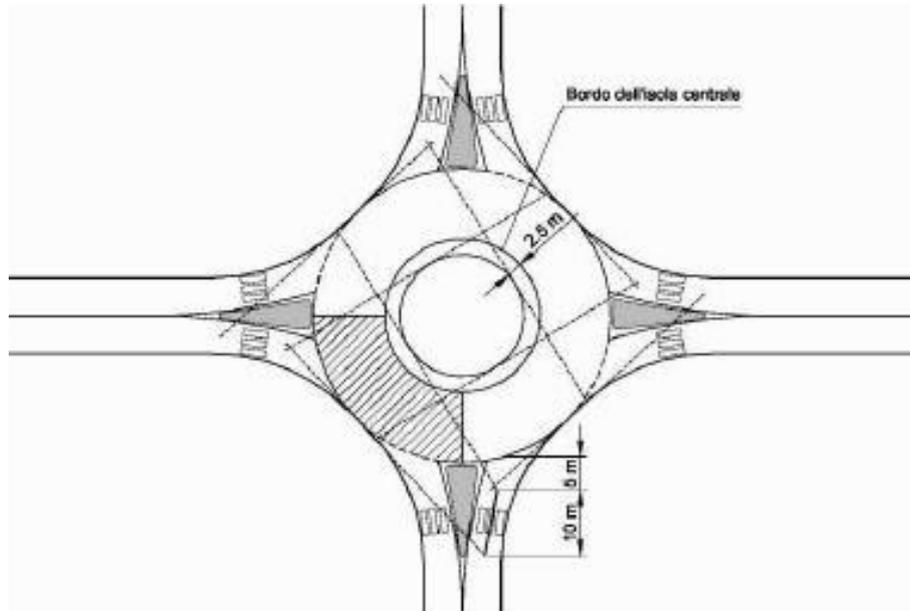
**Figura 8: campi di visibilità in rotatoria**
