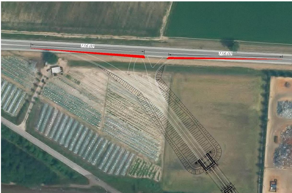
**Figura 7: verifica di visibilità intersezione**
