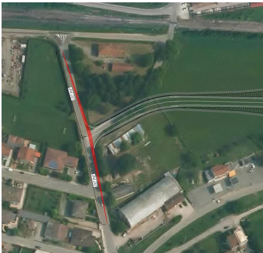
Figura 8: verifica di visibilità intersezione con viabilità locale
