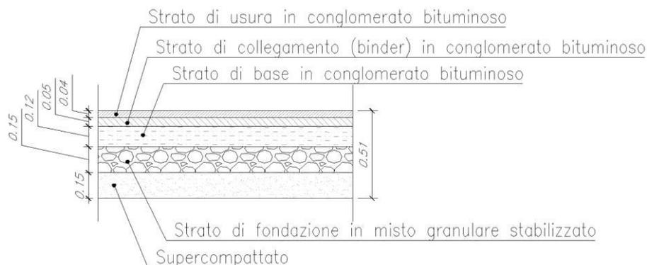
**Figura 4: dettaglio pavimentazione**
