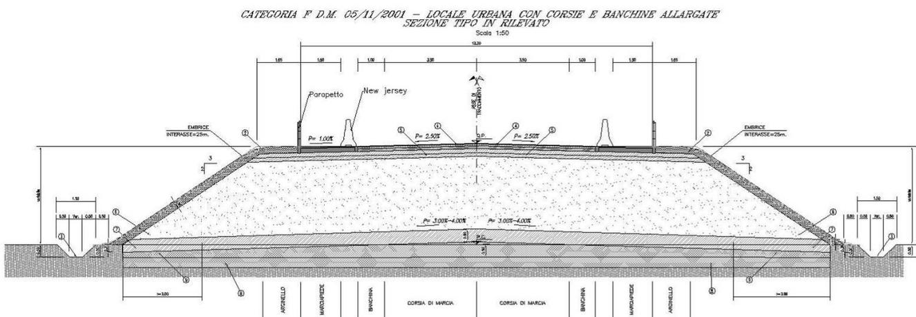
**Figura 3: sezione tipo in rilevato**
