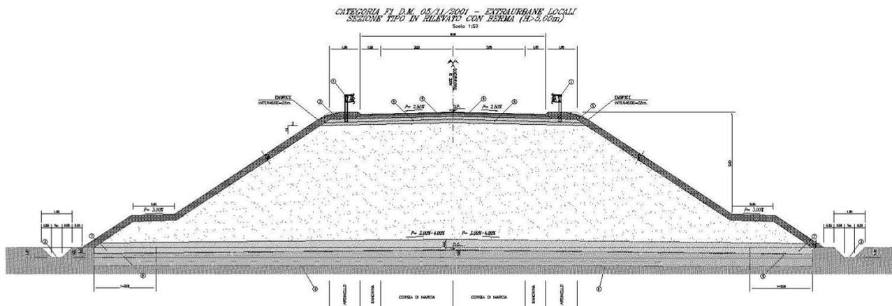
**Figura 5: sezione tipo in rilevato (H > 5,00m)**
