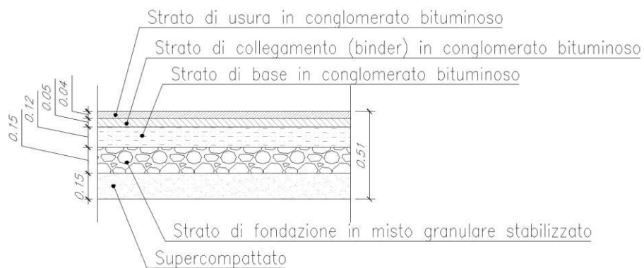
Figura 6: dettaglio pavimentazione
