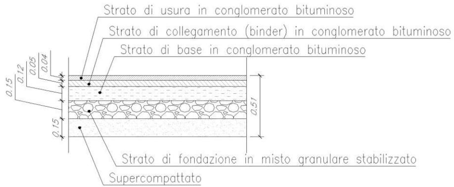
**Figura 6: dettaglio pavimentazione**
