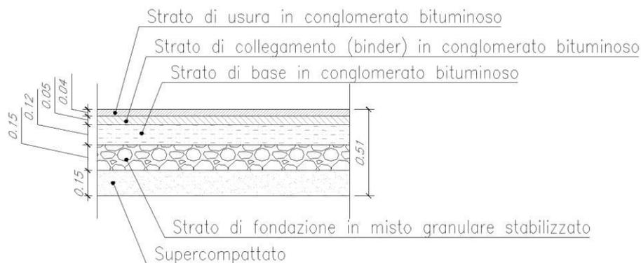
**Figura 4: dettaglio pavimentazione**
