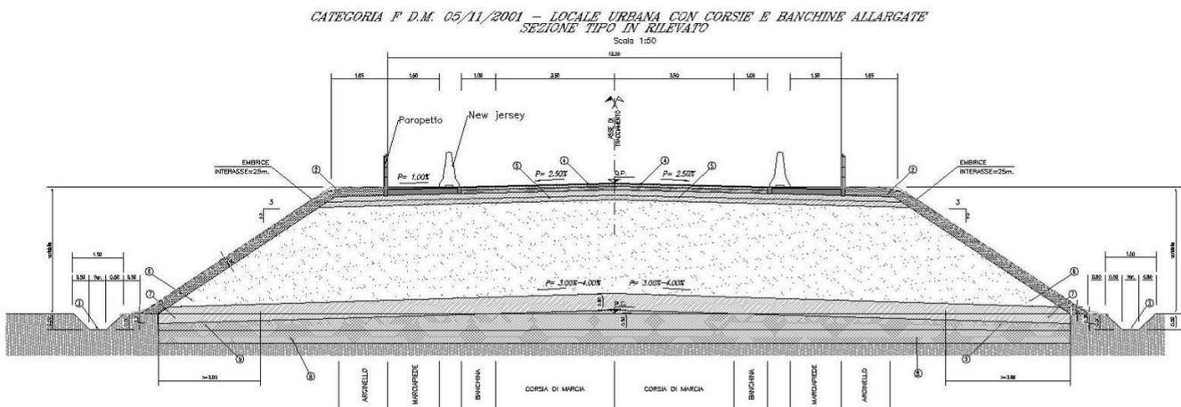
**Figura 3: sezione tipo in rilevato**
