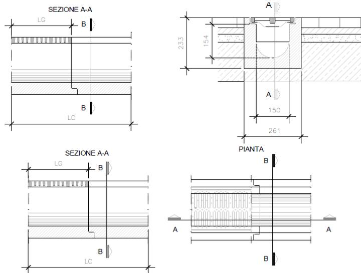
**Figura 5 - Dettaglio canaletta**
