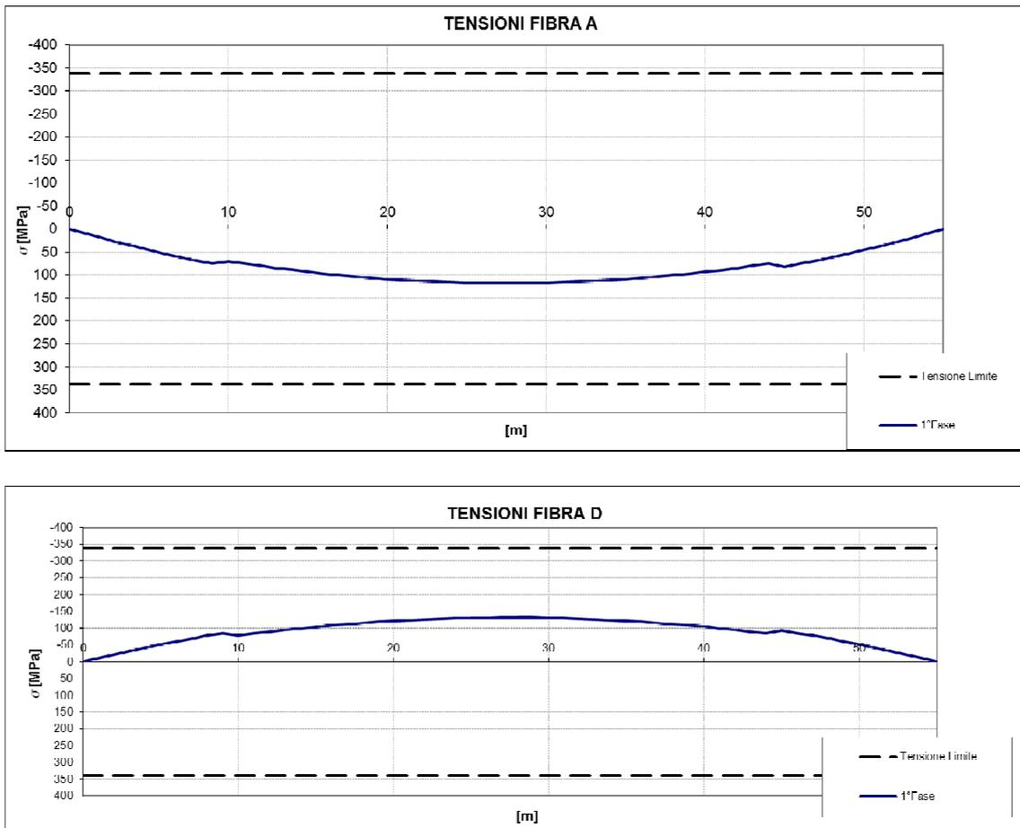
*Figura 15 Peso travi + Peso Soletta (Tensioni normali)*
