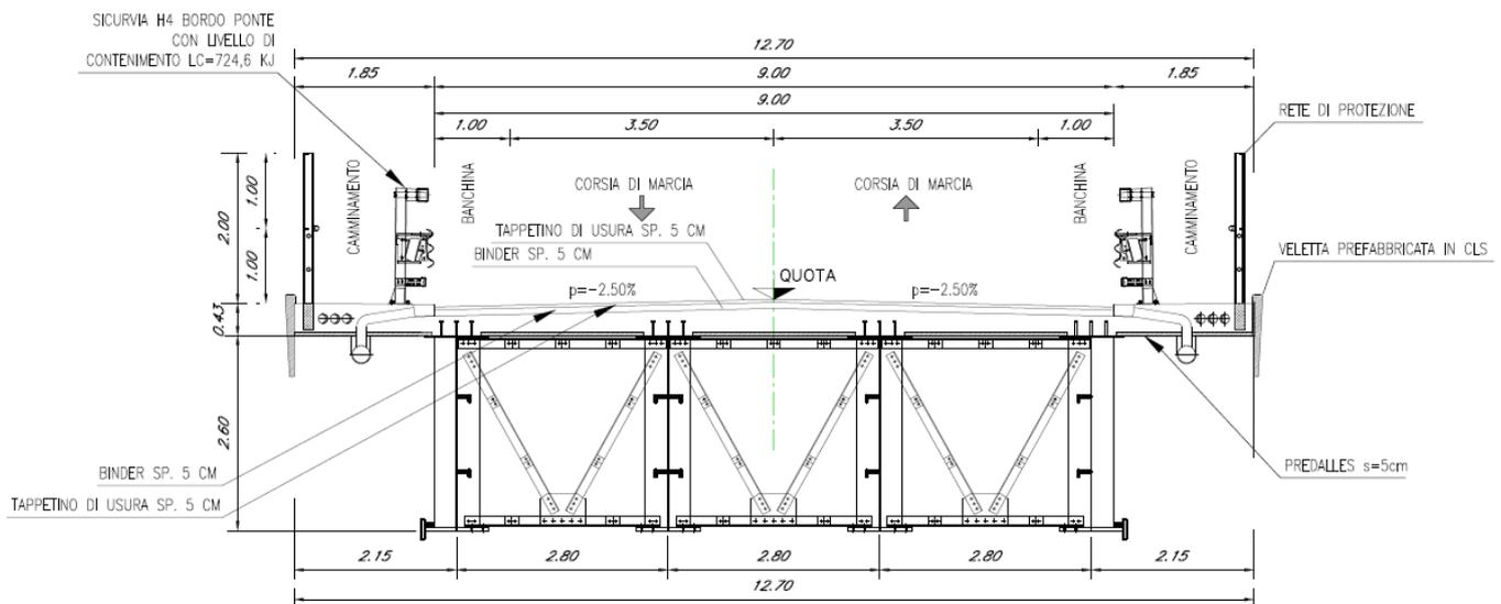
Figura 1- Sezione trasversale tipo dell'impalcato: sezione corrente
