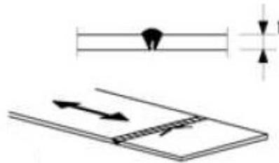
$\Delta\sigma_C = 71$  MPa classe del particolare: limite di fatica per  $2 \times 10^6$  cicli
