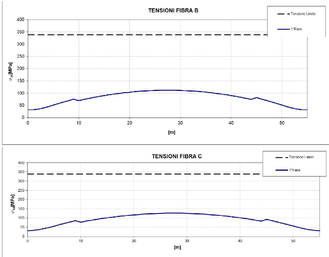
*Figura 16 Peso travi + Peso Soletta (Tensioni ideali)*
