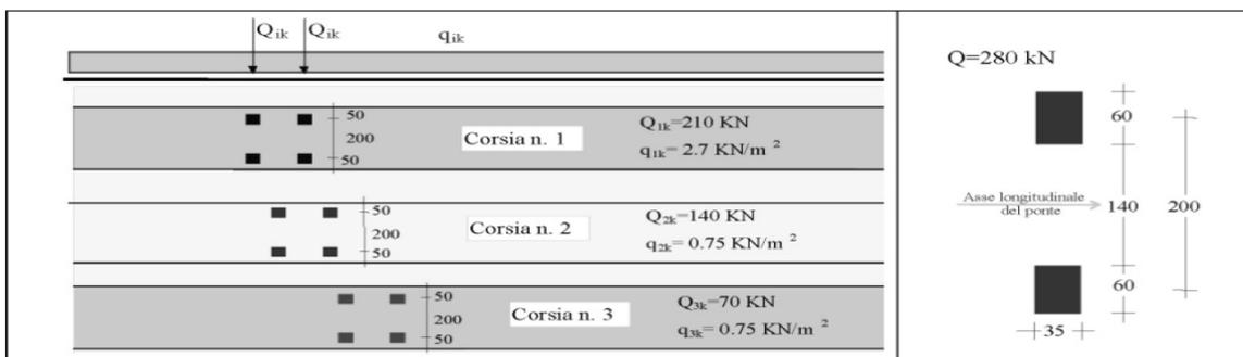
Figura 3 Modello di carico a fatica 1
