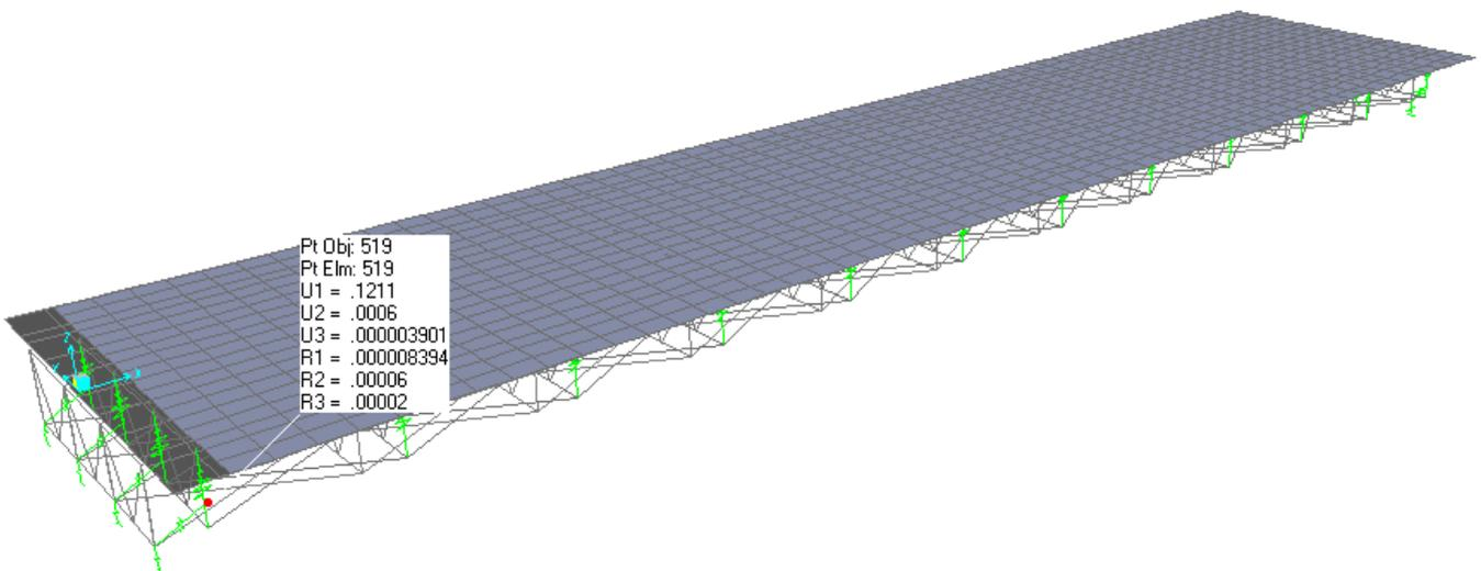
Figura 27 Spostamento longitudinale sisma SLC
