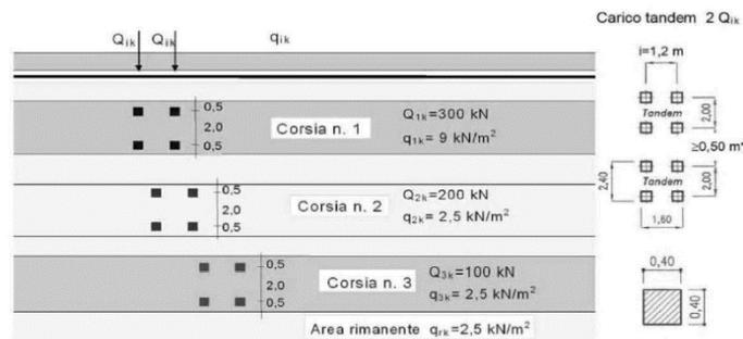
Figura 2: Schemi di carico - carichi  $Q_{ik}$  e  $q_{ik}$ .
