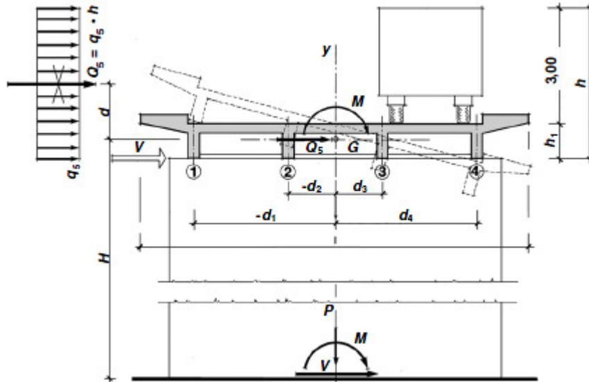
Figura 4: Direzione dell'azione del vento sul ponte
