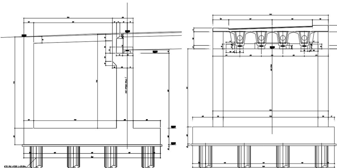
*Figura 5 Carpenteria spalle 1*
