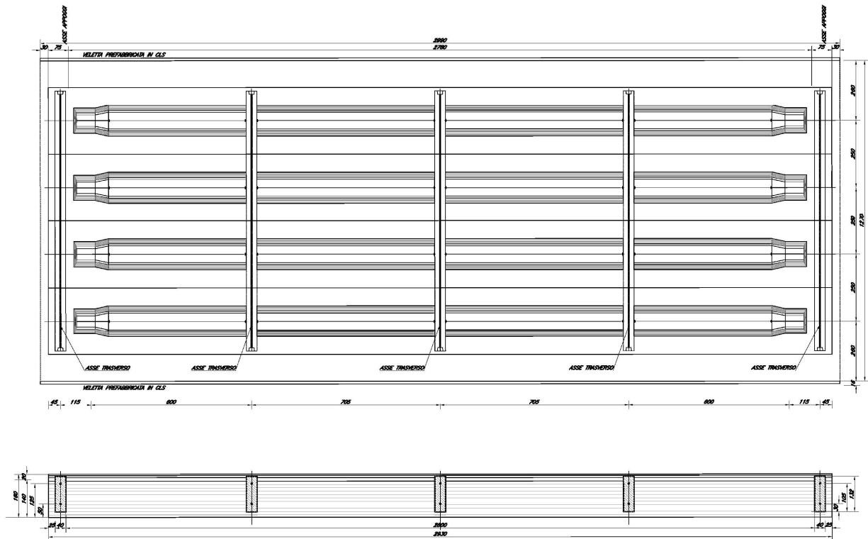
Figura 4 – Pianta e prospetto dell'impalcato
