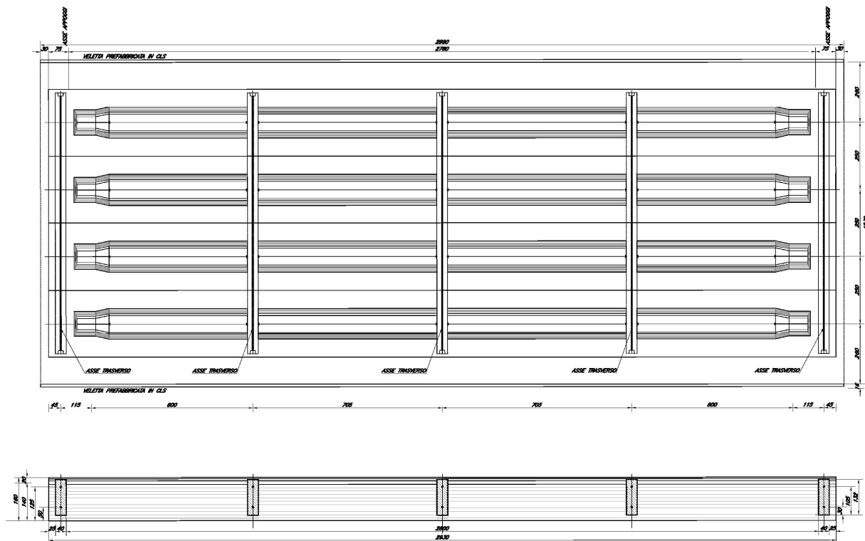
Figura 4 – Pianta e prospetto dell'impalcato
