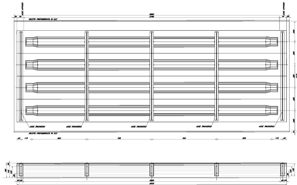
Figura 4 – Pianta e prospetto dell'impalcato
